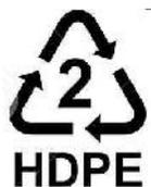
HD-PE-Polietilene ad alta densità, resina termoplastica con elevate resistenze meccaniche, possiede ottime proprietà isolanti e resistenza chimica. Può esistere sotto forma amorfe ( trasparente) cristallina (bianca opaca)
