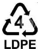
LDPE- Polietilene a bassa densità, materiale termoplastico più duttile e meno rigido dell'HDPE Adatto per film, pellicole e buste flessibili
