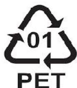
PET-Polietilene tereftalato, resina termoplastica adatta al contatto con alimenti. Ha elevata resistenza chimica e termica (si decompone intorno a 340°C).Può esistere sotto forma:
