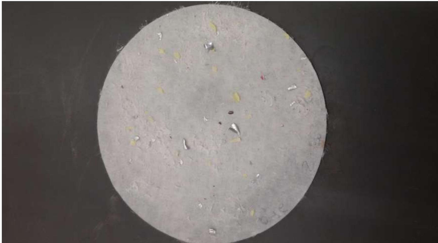
**\*NOTA: nel caso di prevalenza di fiocchi in materiale non cellulosico chiaramente identificabile il risultato dei fiocchi non viene valutato, ma il valore viene sommato allo scarto grossolano (calcolato sul peso del prodotto di partenza)**
